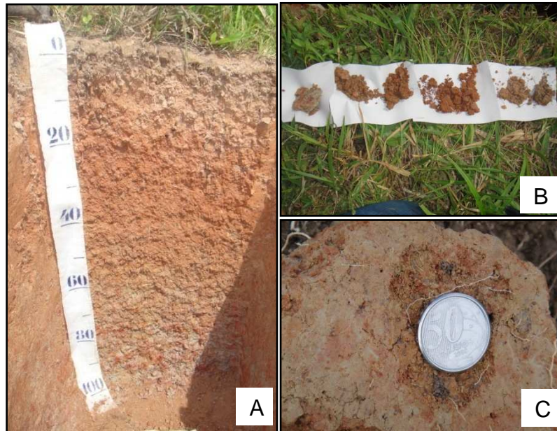
FIGURA 9 – Perfil do solo no Experimento 1. Perfil do solo (A); separação dos horizontes do perfil do solo (B); e presença de pequenas concreções de manganês nos horizontes BC e C (C).
