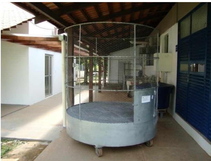
Figura 6 - Protótipo do secador utilizado no experimento durante armazenagem da castanha-do-brasil.
