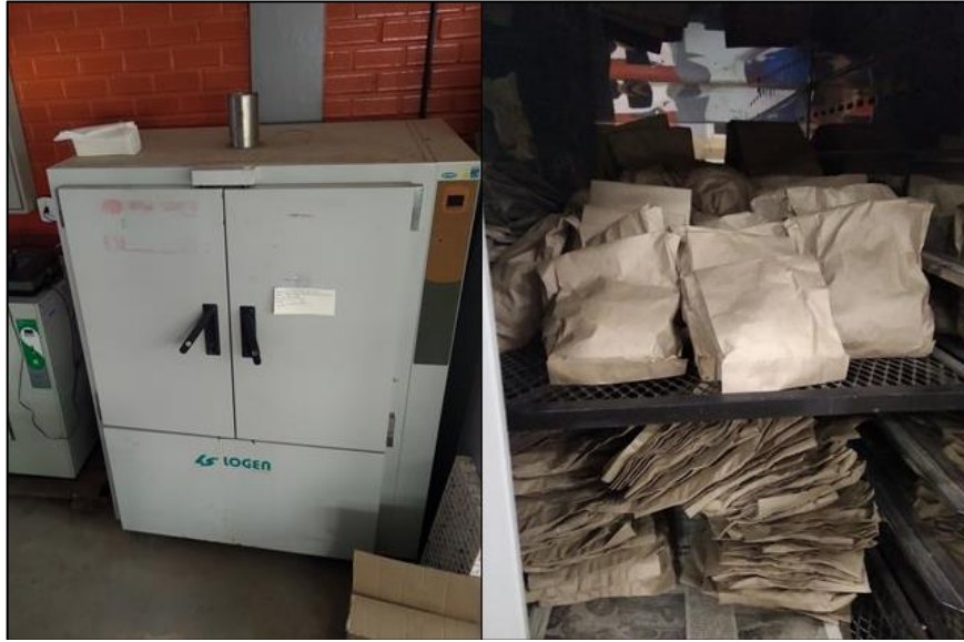
Figura 15 – Secagem dos frutos de Capsicum chinense em estufa a 65° no Laboratório de Fitotecnia da UFAC, Rio Branco, Acre, 16/08/2020.
