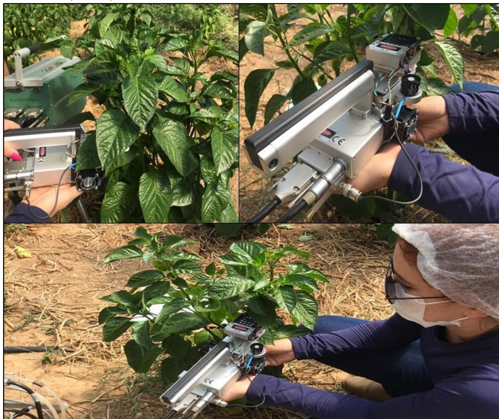
Figura 20 – Análise de trocas gasosas em plantas de Capsicum chinense com auxílio do analisador de gás no infravermelho (IRGA) com fluorômetro acoplado, UFAC. Rio Branco, Acre, 01/09/2020.
