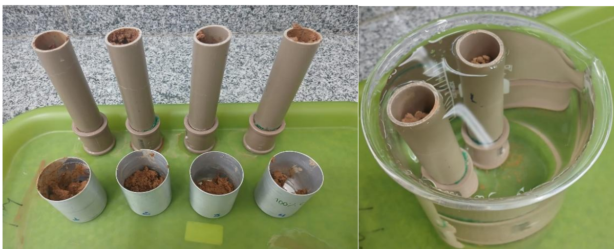
Figura 2. Determinação da capacidade de campo por saturação e drenagem livre em solo utilizado no experimento
