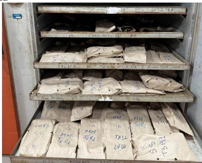
Figura 5. Secagem de Panicum maximum cv. Mombaça em estufa de circulação de ar forçada
