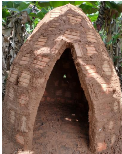
Figura 1 - Forno de pirólise artesanal projetado para produção de biocarvão. Foto: Conceição Paula Bandeira Rufino. Rio Branco, AC, 2025.
