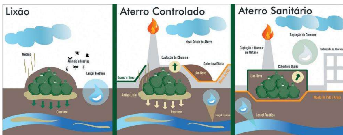
Figura 1 – Ilustração de lixão, aterro controlado e aterro sanitário
