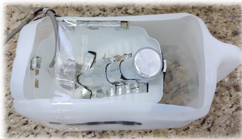
Figura 1: Recipiente plástico adaptado e confeccionado utilizando-se um galão de cinco litros para uso do transdutor de ultrassom submerso em água.
