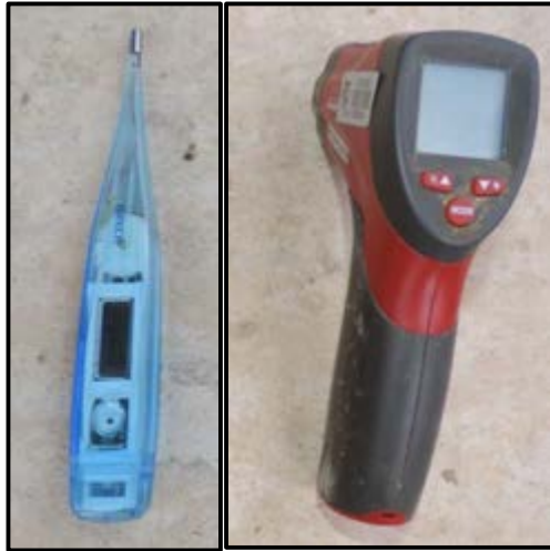
APÊNDICE G. Aparelhos utilizados na coleta de temperatura das aves, cloacal (esquerda) e superficial (direita).
