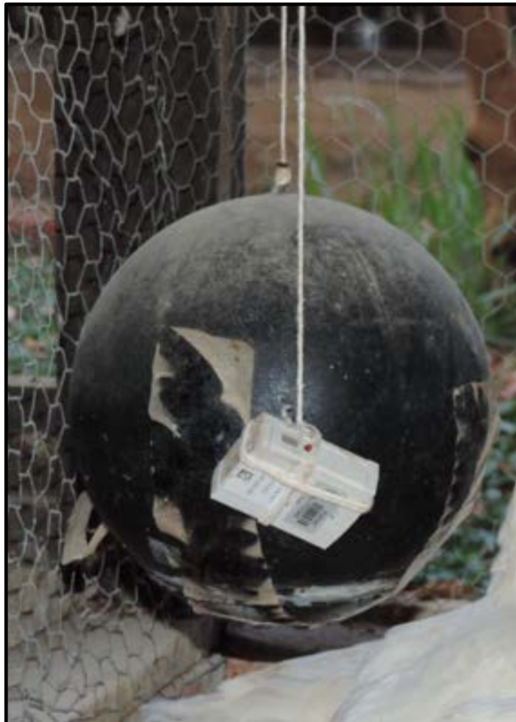
APÊNDICE H. Aparelhos utilizados na coleta das variáveis climáticas no microclima (Datalogger e Globo negro).
