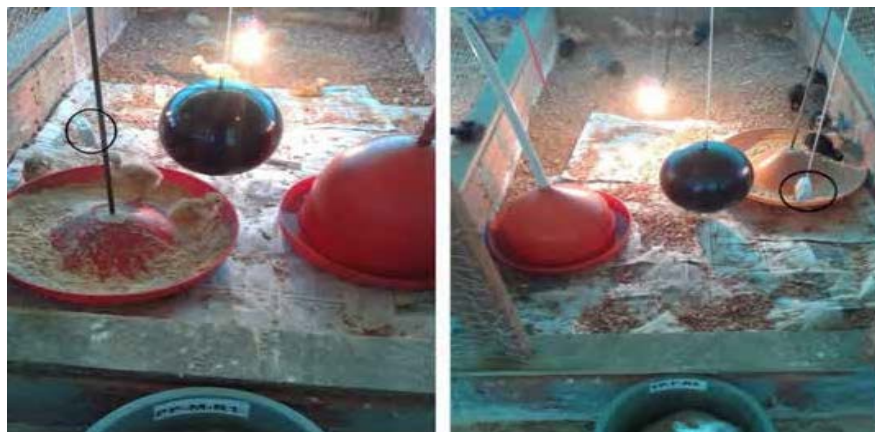
Figura 4. Globo negro e “data loggers” utilizados nos boxes experimentais.
