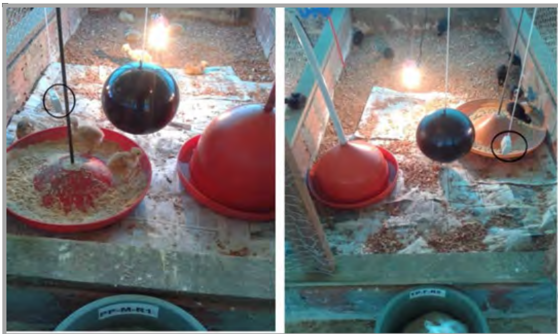
Figura 3. Vista geral dos “data loggers” e globo negro, instalados ao nível das aves, nos boxes experimentais.
