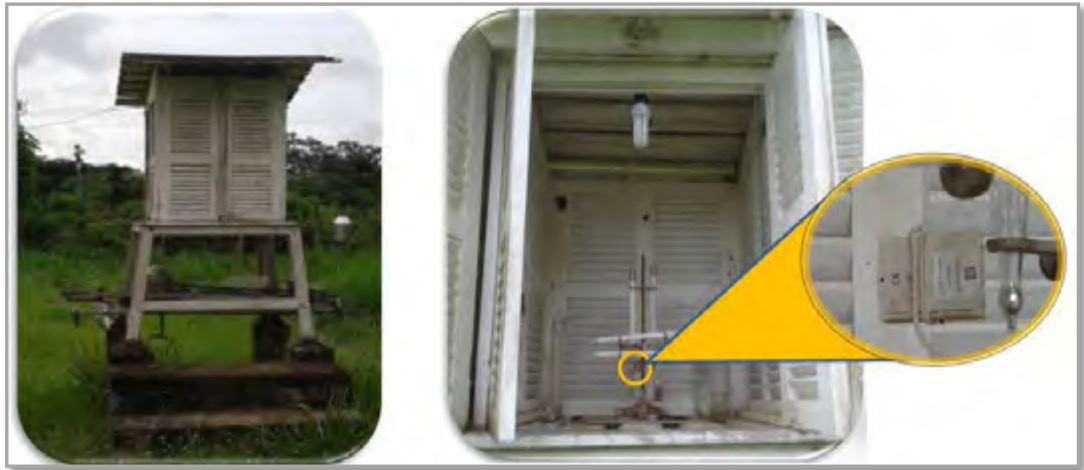
Figura 4. Vista do abrigo meteorológico e localização do equipamento próximo ao galpão experimental, visando caracterização do ambiente externo.
